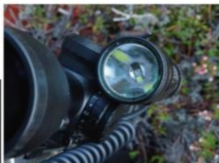
Lykta veksler mellom hvitt og grønt lys ved å flytte de to diodene fram og tilbake. På bildet ses begge og det er hvit som er koblet inn.
